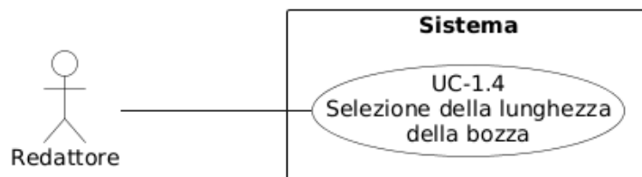
Figura 5: Diagramma del caso d'uso UC-1.4: Selezione della lunghezza della bozza
