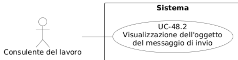
Figura 79: Diagramma del caso d'uso UC-48.2: Visualizzazione dell'oggetto del messaggio di invio
